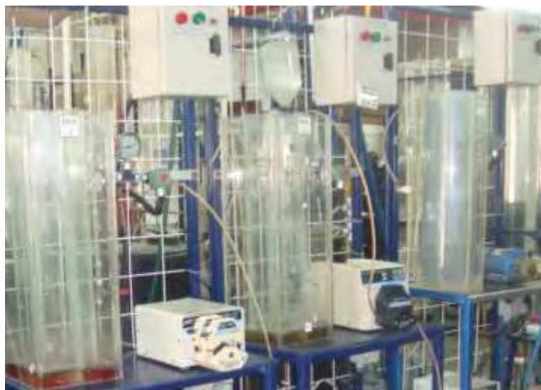
Figura 3.2. Fotografía de los biorreactores con membrana sumergida.
