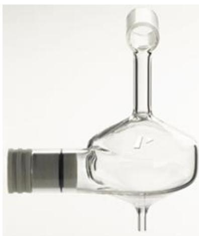
**Figura 1.12** Cámara de rocío ciclónica. <sup>(19)</sup>
