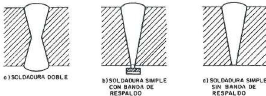
Fig. 1-17. Tipos de Soldadura.
