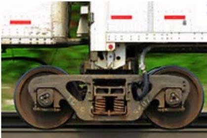
Cada unidad Road Railer cuenta con un sistema de suspensión de aire que permite posicionar la caja sobre el “bogie ferroviario” sin necesidad de ser levantada por una grúa.
