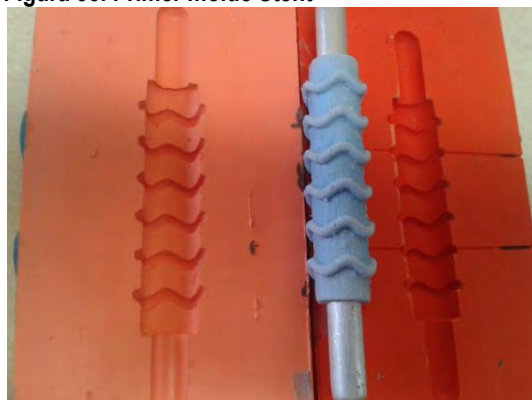
Figura 35 Molde Stent con corazón altamente deformable
