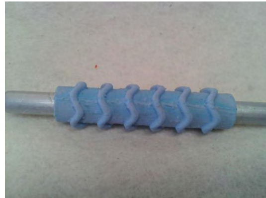
Figura 34. Primer vaciado de Stent en material flexible
