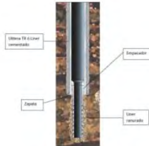
Fig 9.3 Terminación en tubería ranurada sin cementar
