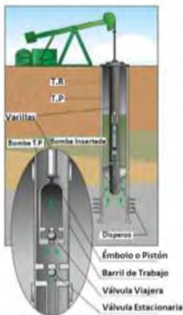
Fig 9.8 Sistema de Bombeo Mecánico (BEC)
