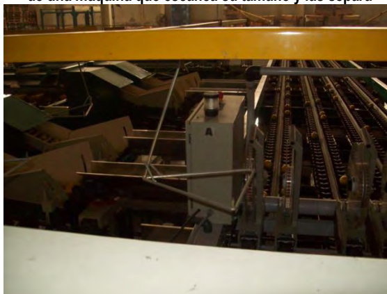
Figura 3.59. El proceso de selección puede ser a través de una máquina que escanea su tamaño y las separa
