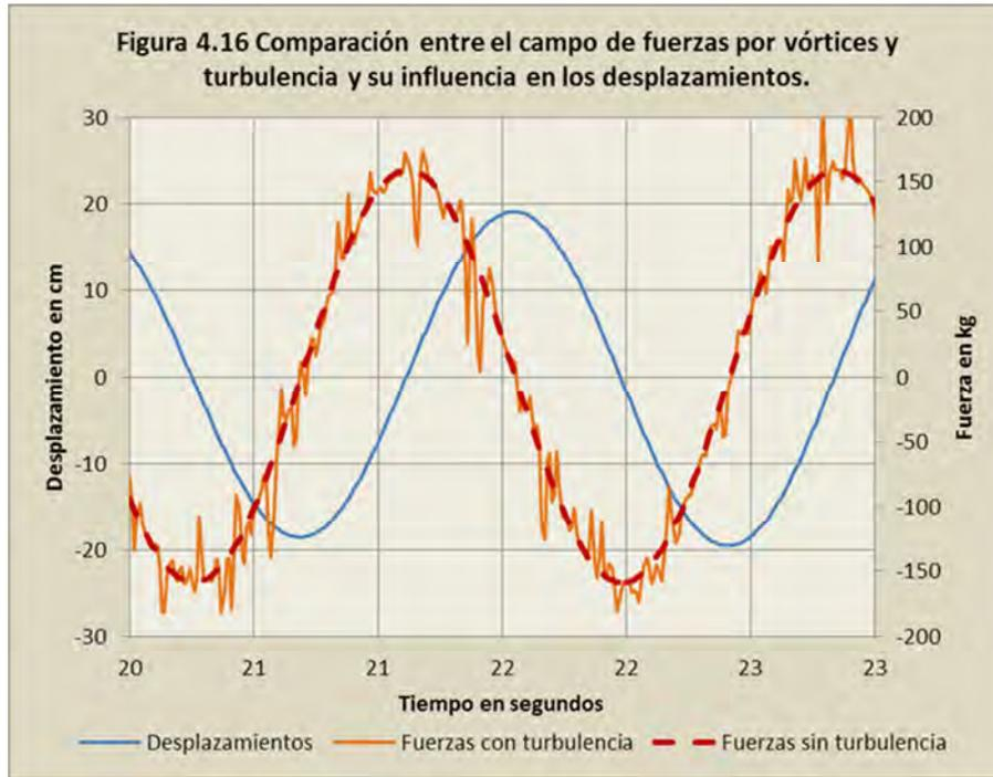
Por el contrario, si el viento se encuentra estratificado y con turbulencia mínima o nula, no existen los efectos de turbulencia de gran escala, por lo que la estructura tiene tiempo para desarrollar grandes desplazamientos, que a su vez conducirán a estados de esfuerzos inaceptables.
