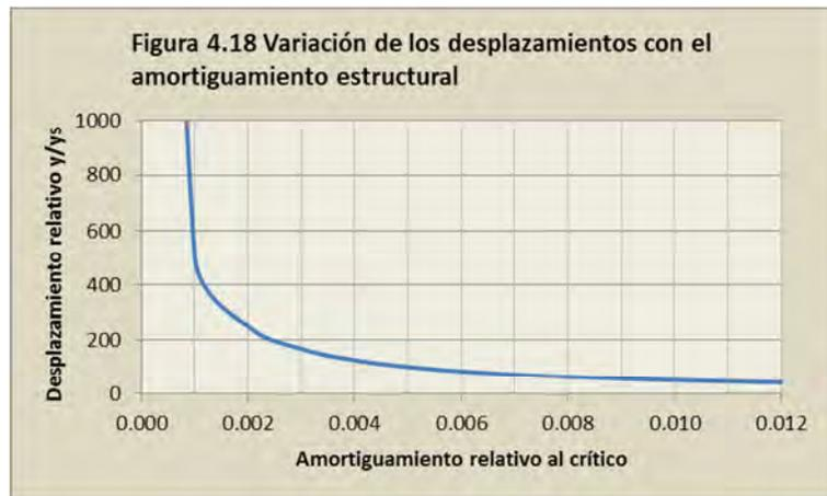
El parámetro más importante que limita los desplazamientos de una chimenea metálica es el amortiguamiento.
