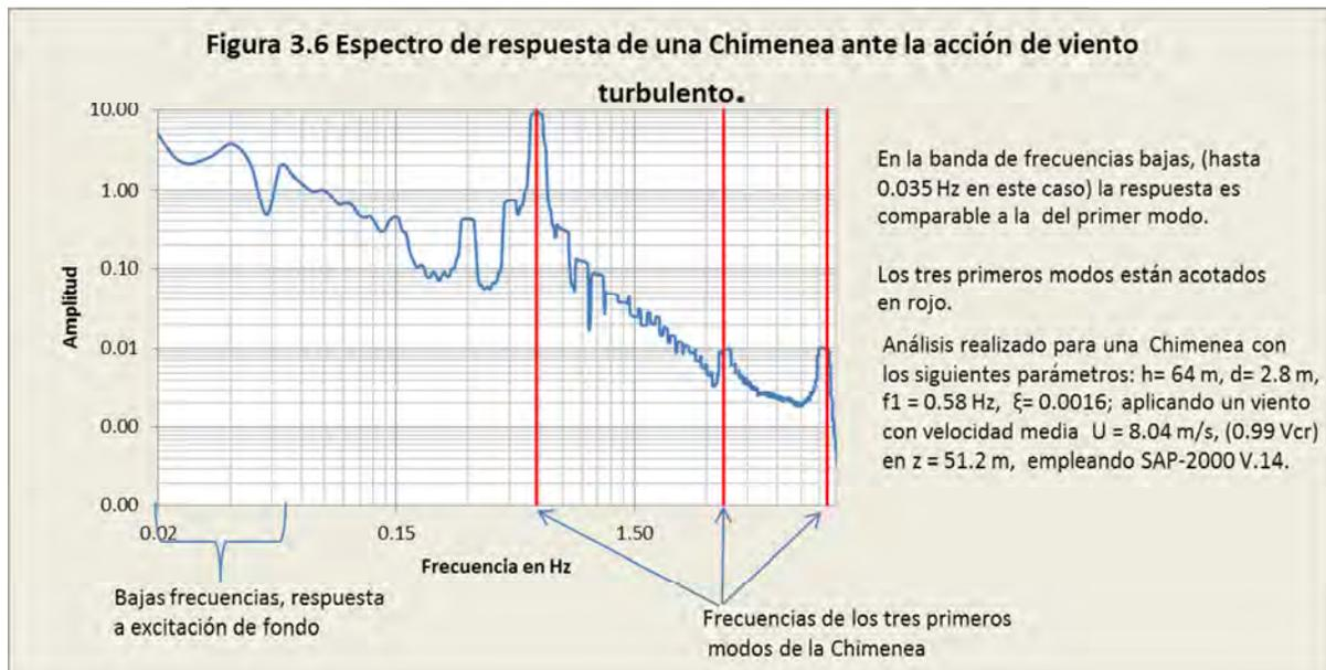
De acuerdo a lo indicado, el viento puede modelarse como la suma de la velocidad media y la componente turbulenta, la cual tiene media nula; además de su magnitud, ( $I_u$ ) la turbulencia debe entenderse, como la suma de una diversidad de componentes armónicas, y ante cada una de ellas, la estructura presentará una respuesta particular.
