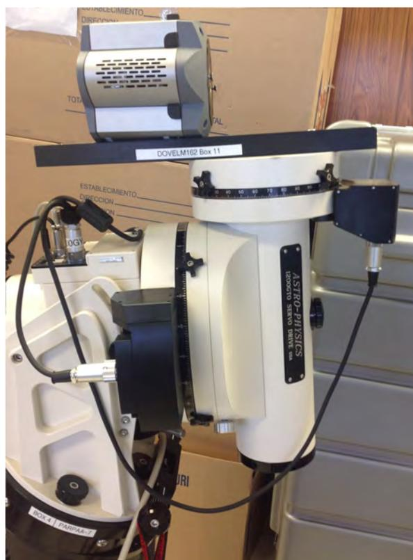
**Figura 4.14:** Acoplamiento de la cámara EMCCD Andor iXon +897 al soporte superior de la montura para simular los movimientos en R.A. y Dec..
