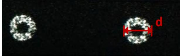
**Figura 4.11:** Imagen del patrón de centelleo de una estrella doble. Se ve claramente el disco central formado por la obstrucción del espejo secundario. El valor de  $d = a_{ef}$ .
