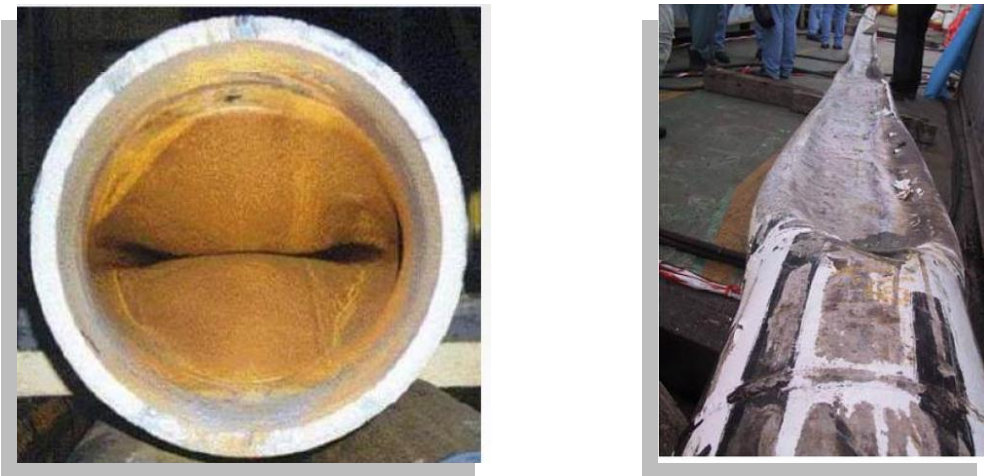
Figura 19. Fallo por colapso
