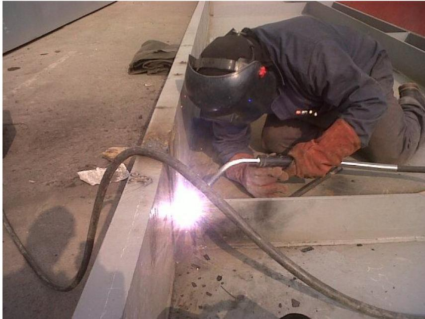
**Imagen 32. Soldadura protegida con CO<sub>2</sub>**
