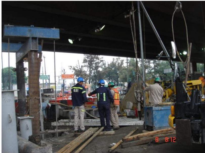
Imagen 4. Sondeo con cono eléctrico
