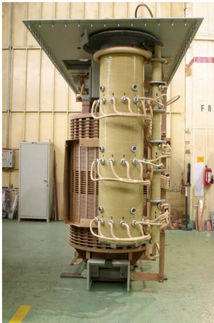
FIGURA 3.1. Foto de la instalación de un cambiador de derivaciones tipo interno en fábrica.
