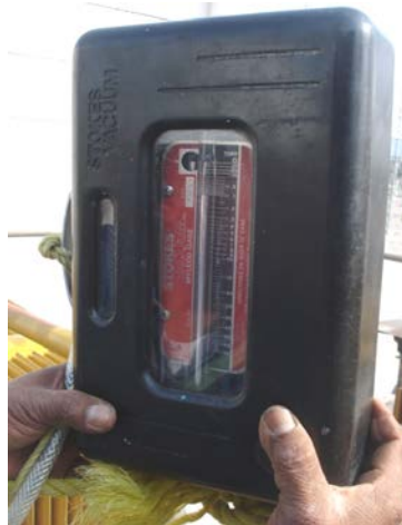
FIGURA 3.2. Fotografías; a) conexión de la bomba de alto vacío, b) vacuómetro de la bomba.
