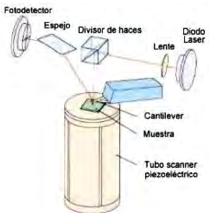
Fig. 2.1. Esquema del funcionamiento de un microscopio AFM
