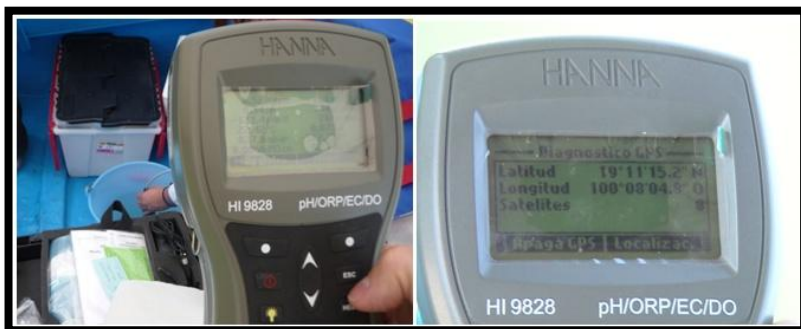
Figura 3. 11 Medidor multiparamétrico con GPS HI 9828
