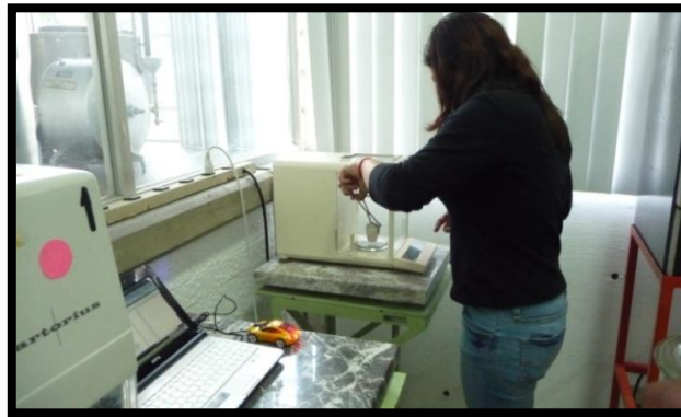
Figura 3.18 Cálculo del peso total del crisol Gooch con contenidos de sólidos suspendidos
