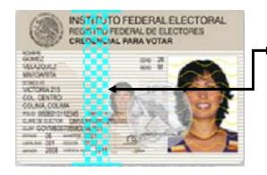
Generado por un procedimiento que puede almacenar información en imágenes con la manipulación controladora de pixeles. Requiere instrumentos para su verificación.
