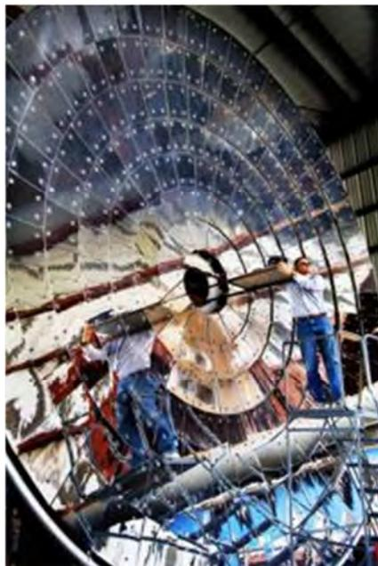
Figura 2.11 Horno solar de los Laboratorios Nacionales de Sandia. [2.7]
