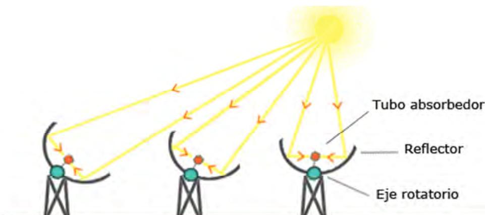
Figura 1.13 Funcionamiento de un Disco Cilindro Parabólico. [1.19]
