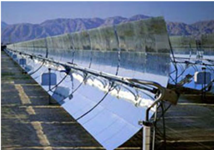
Figura 1.3 Colector actual de concentración. [1.17]
