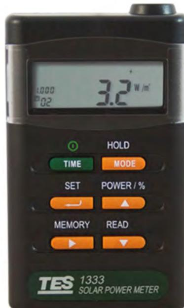
Figura 4.16 Medidor de Radiación Solar. [4.2]
