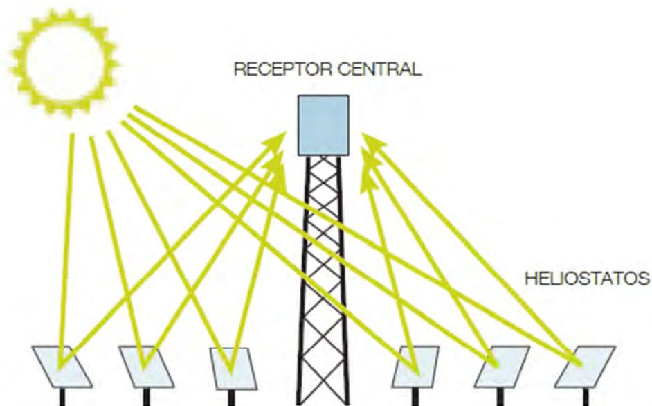
Figura 1.11 Funcionamiento de una Torre Central. [1.14]
