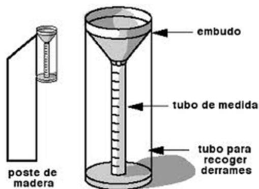
Figura 3.7 Pluviómetro. [3.5]
