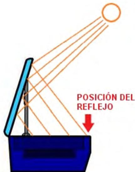
Figura 1.7 Funcionamiento de un Horno Solar. [1.19]
