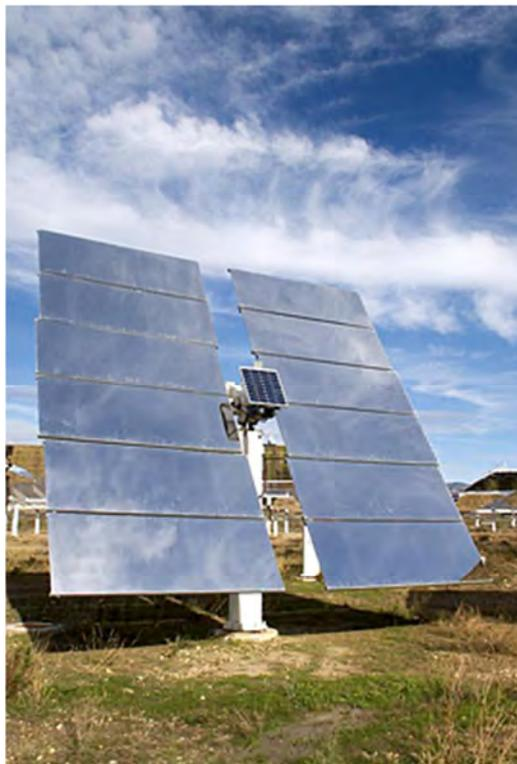
Figura 2.5 Helióstato autónomo del campo CRS. [2.14]
