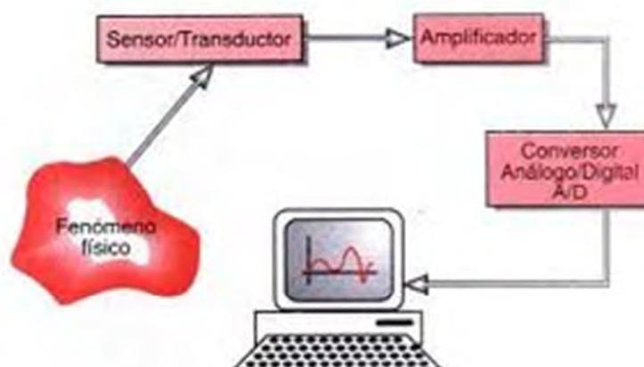
Figura 3.1 Sistema de Adquisidor de Datos. [3.3]
