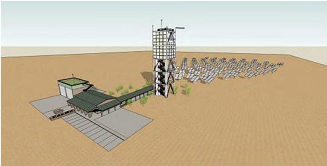
Figura 2.27 Esquema del campo de pruebas para los helióstatos en México. [2.9]
