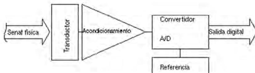
Figura 3.2 Esquema de Adquisidor de Datos. [3.3]
