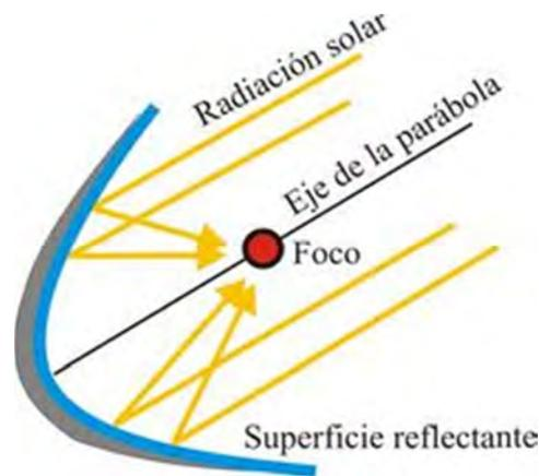
Figura 1.9 Funcionamiento del concentrador solar parabólico. [1.12]
