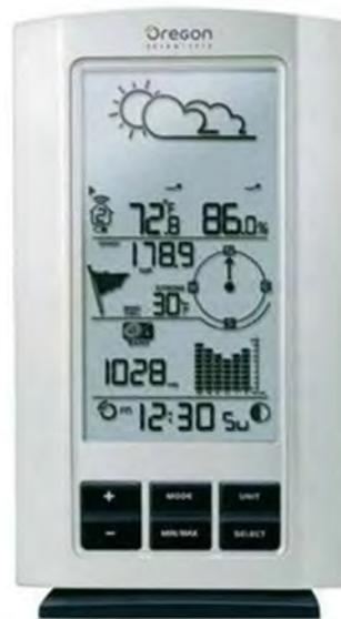
Figura 4.17 Estación meteorológica. [4.5]
