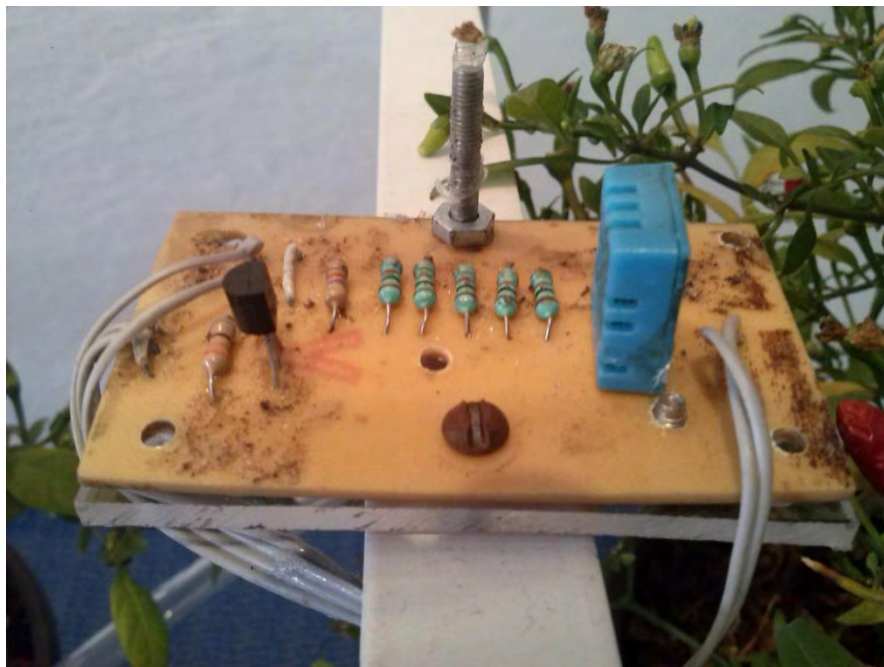
Figura 6.6 Sensores de temperatura y humedad relativa DALLAS Y DHT11
