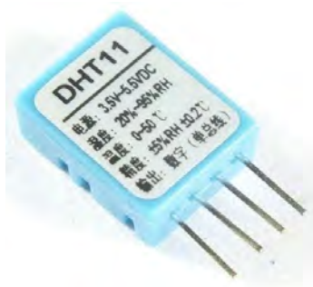
Figura 1.13 Sensor de humedad y temperatura DHT11
