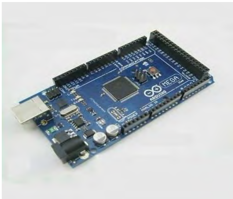
Figura 1.6 Microcontrolador ATMEGA2560 de la marca ATMEL
