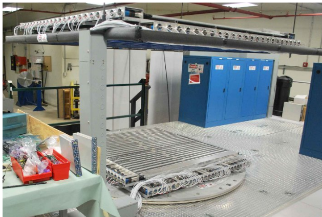
(b) Rastreador de muones y fuentes de alto voltaje.
