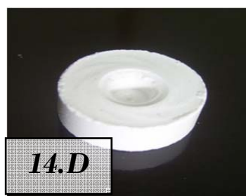
Figura 14. C y D Comprimidos manufacturados con punzón modificado.
