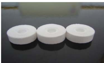
Figura 16. Comprimidos con cavidad central por compresión directa.
