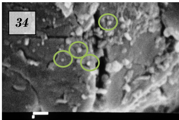
Figuras 34 y 35. Micrografías del interior del comprimido con nanopartículas infiltradas de etil celulosa (10000X).
