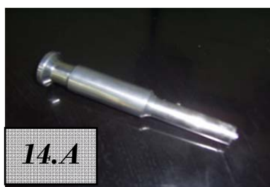
Figura 14. A y B Punzón superior modificado.
