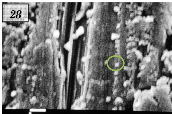
Figura 28. Micrografías de la superficie del comprimido con nanopartículas de etil celulosa (10000X).
