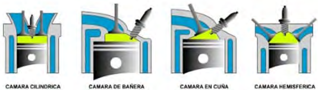
Figura 8. Tipos de Cámaras de Combustión
