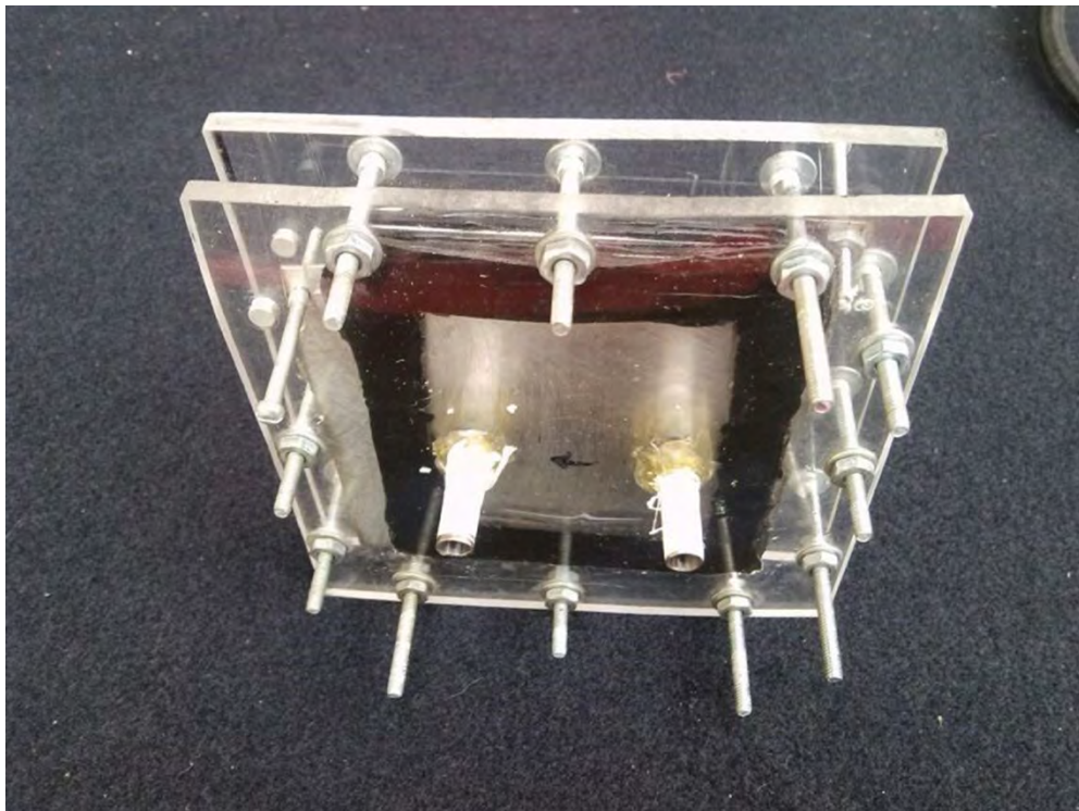
Figura 76. Celda terminada con acrílico.
