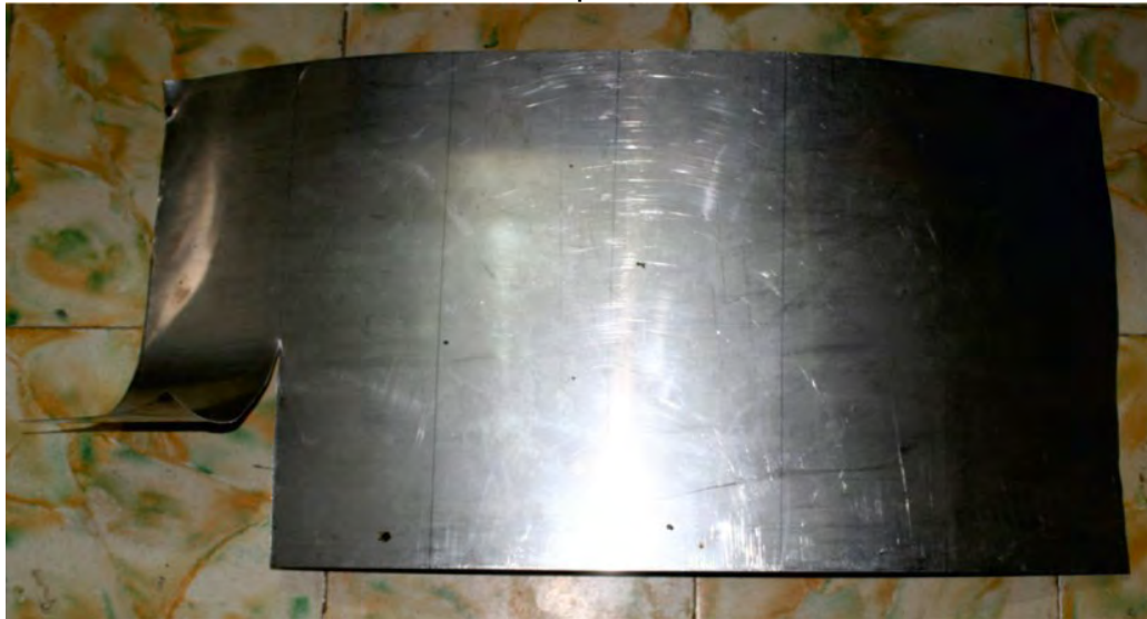
Figura 68. Placa de acero Inoxidable 316.
