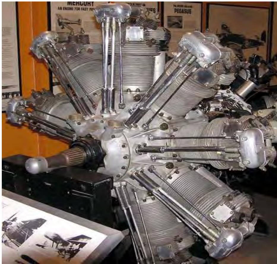
Figura 23. Motor de aviación Bristol Júpiter, enfriado por aire. Son claramente visibles las aletas de refrigeración de los cilindros, utilizadas para aumentar la superficie de disipación
