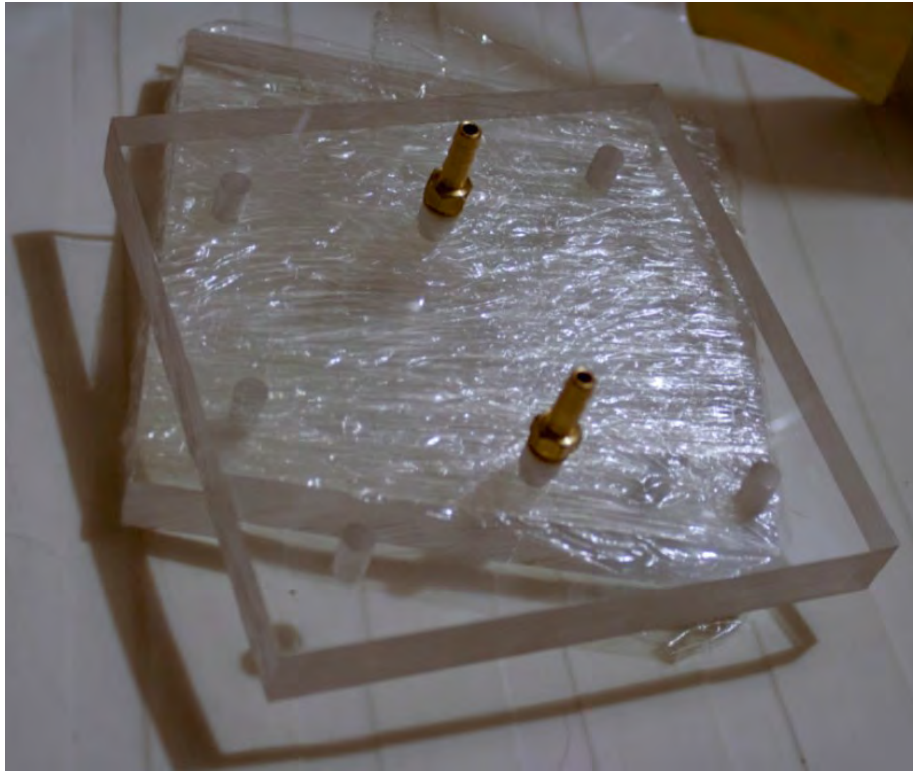
Figura 75. Conexiones para manguera tipo NPT macho (cónico).
