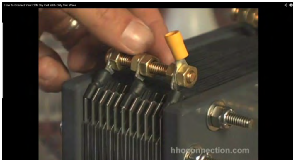
Figura 84. En la figura se muestra la correcta instalación de la terminal eléctrica.
