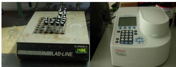
Figura 4.4. Equipo utilizado en la determinación de DQO. De izquierda a derecha: calentador para tubos de ensayo y espectrofotómetro uv.
