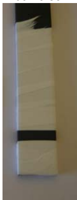
Figura 3.3 Electrodo de diamante dopado con boro (BDD) con un área expuesta de 1\text{ cm}^2 .
