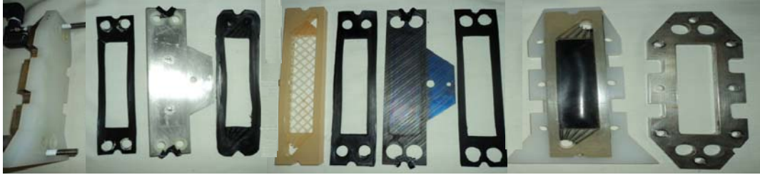
Figura 4.2. Conformación del FM01-LC. De izquierda a derecha: placa trasera, empaque, electrodo de acero inoxidable(cátodo), empaque, canal de distribución con promotor de turbulencia, empaque, electrodo DSA 1 (ánodo), empaque, canal de distribución y placa trasera
