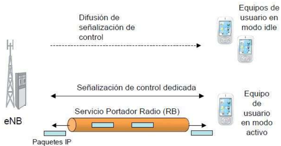
Figura 3.6 Ilustración de los mecanismos de transferencia de información en la interfaz radio
