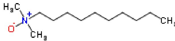
**Figura 5.6** Óxido de amina, ejemplo de tensoactivo zwitterionico.
