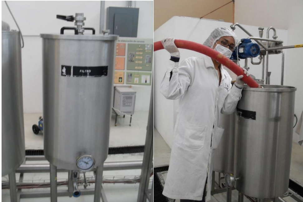
Figura 26. Tanque de filtración SO3 de la Planta Piloto Educativa para elaborar Cerveza (derecha) y personal transfiriendo el mosto al tanque de filtrado (izquierda).
