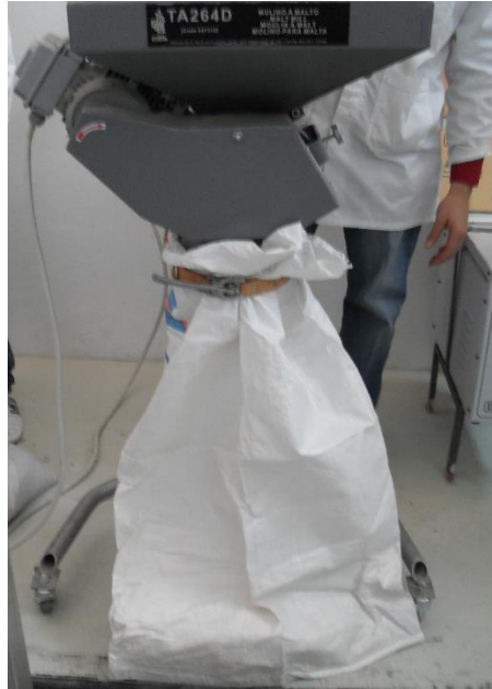
Figura 22. Molino de para cereales Didacta Italia modelo TA264D.
