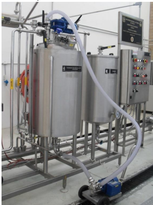
Figura 39. Ejemplo de armado del ciclo continuo empleado en la limpieza y desinfección de la Planta Piloto Educativa.
