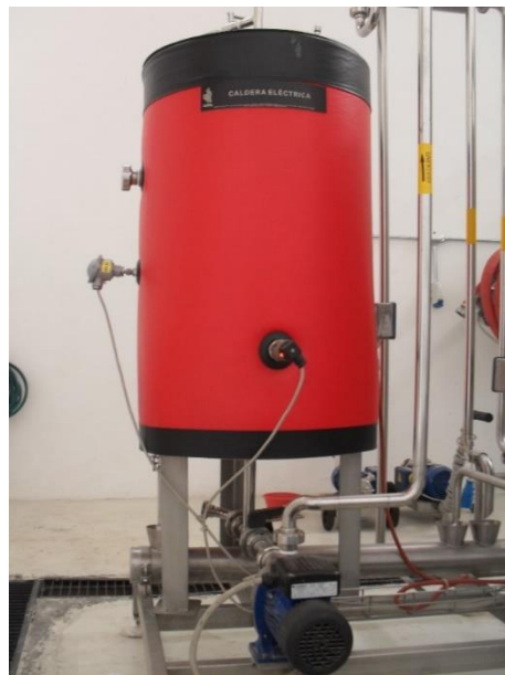
Figura 38. Caldera o Tanque SO1 de la Planta Piloto Educativa para elaborar Cerveza.
