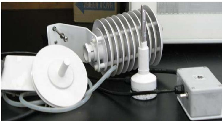
Figura 14. Sensor de temperatura, humedad y presión.
