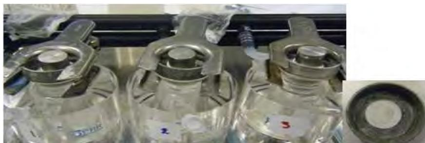
**Figura 2.2** Celdas de Franz modificadas para la liberación in vitro de 5-ALA a un medio receptor de amortiguador pH 4.5
