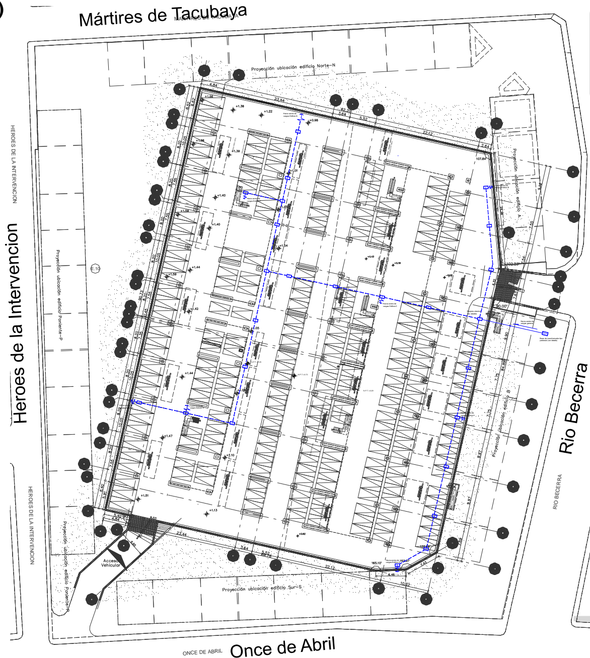
Ilustración 95. Planta de conjunto de la acometida eléctrica que entra por la calle de Rio Becerra, llegando al transformador de tipo pedestal.
