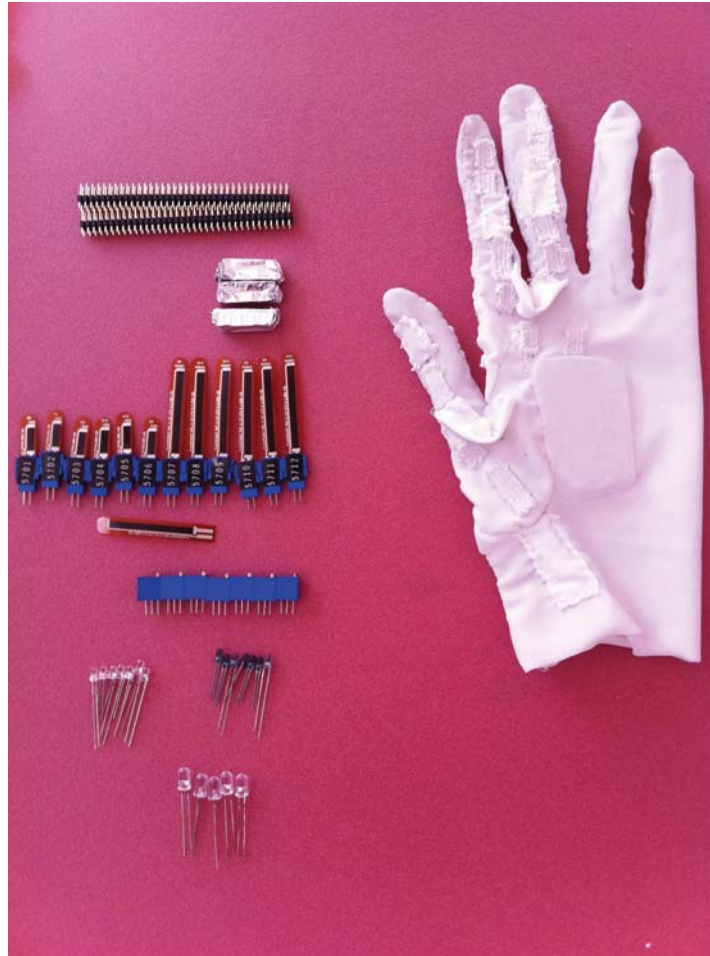
Figura 2.12. Guante instrumental, sensores optoelectrónicos, piezoeléctricos y potenciómetros.
