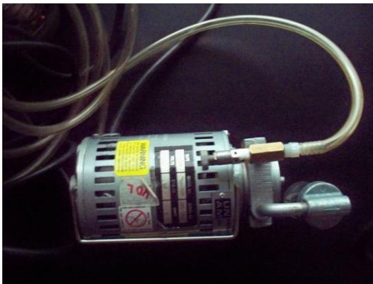
Figura 7. Bomba o sistema de vacío Andersen
