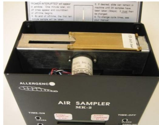
Figura 8. Montaje del portaobjetos con agar en la trampa de esporas Allergenco previo a cada muestreo.
