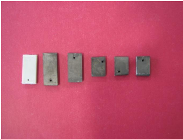
b) PBT metalizado, la pieza blanca es el mismo PBT sin recubrir.
