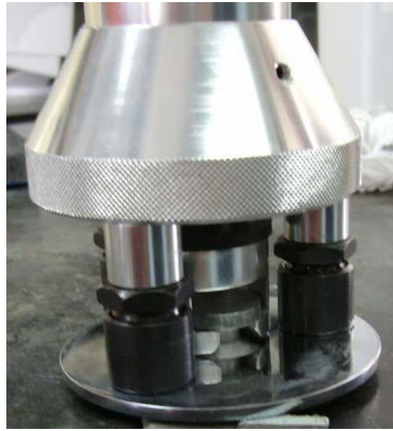
Fig. 4.25 Equipo para medición de adherencia marca Elcometer 106 según norma ASTM 4541
