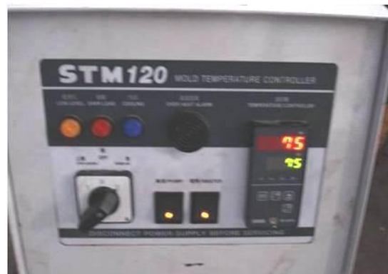
Figura 4.6 a) Molde empleado para piezas de PBT, b) controlador de temperatura de la boquilla, c) atemperador del molde.
