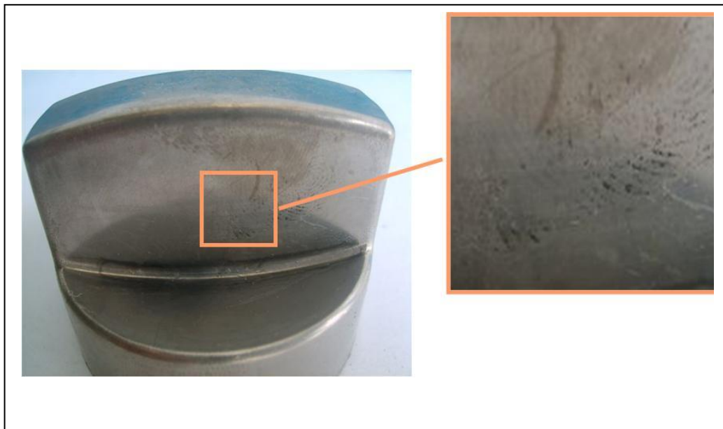
Fig. 5.2 Defecto en pieza metalizada por falta de limpieza. El recuadro muestra la visualización de la huella dactilar impresa.
