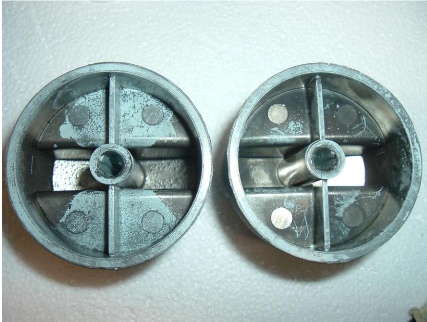
Fig. 4.23 Comparación de las muestras de PBT en zonas críticas tanto de las muestras lisas como de las rugosas después del primer ciclo de metalizado.
