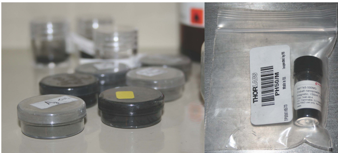
Figura 3.2.2. Nanopartículas utilizadas. Ag, Co-C, NTC (multipared), NTC (pared sencilla).
