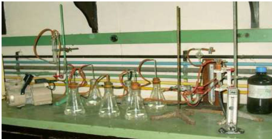
Fig.16. Equipo para la determinación de la capacidad dinámica de adsorción de humedad. Fuente :Martín y Velázquez (2012)
