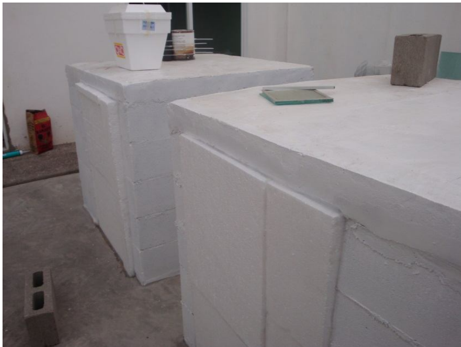
Fig. 103. Montaje experimento VI . Ambas células se cierran con los paneles de poliuretano. Fuente: Propia
