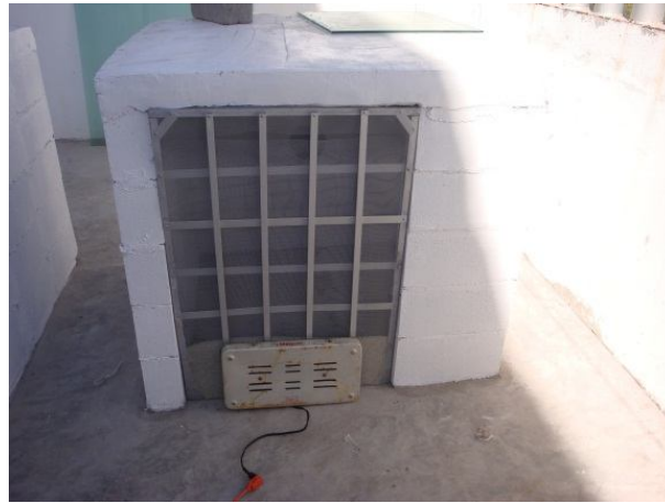
Fig. 86. Montaje de Experimento II Se calienta la zeolita con fogón eléctrico. Fuente: Propia
