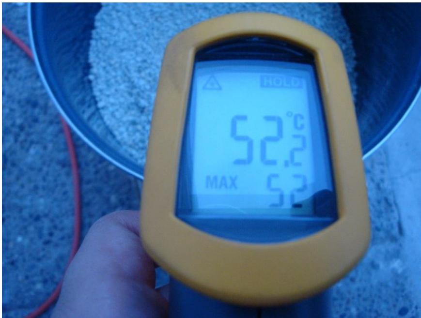
Fig. 101. Montaje experimento VI . La zeolita es calentada hasta alcanzar temperaturas cercanas a los 100°C, después se deja reposar hasta alcanzar los 48°C. Fuente: Propia
