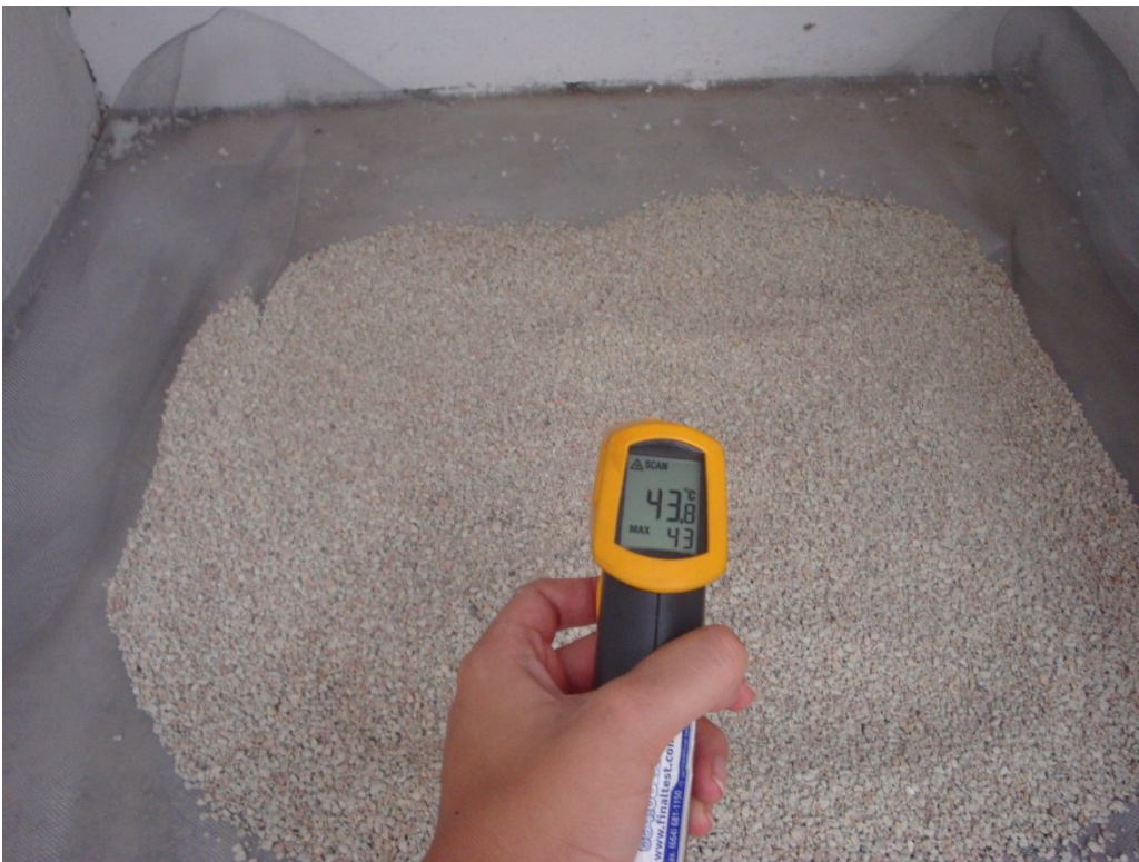
Fig.108. Montaje experimento IX. Se verifica la temperatura de la zeolita dentro del módulo. Fuente: Propia.
