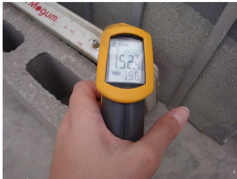
Fig. 96. Montaje experimento V. La zeolita es calentada con una estufa eléctrica. Se pretende llevar el material desecante cerca de los 100°C . En este caso la zeolita alcanzó los 152°C. Fuente: Propia
