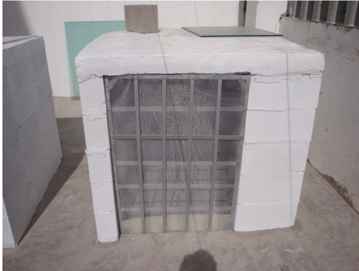
Fig. 80. Montaje de Experimento I con 2 Kgs de zeolita en el artefacto desecante
