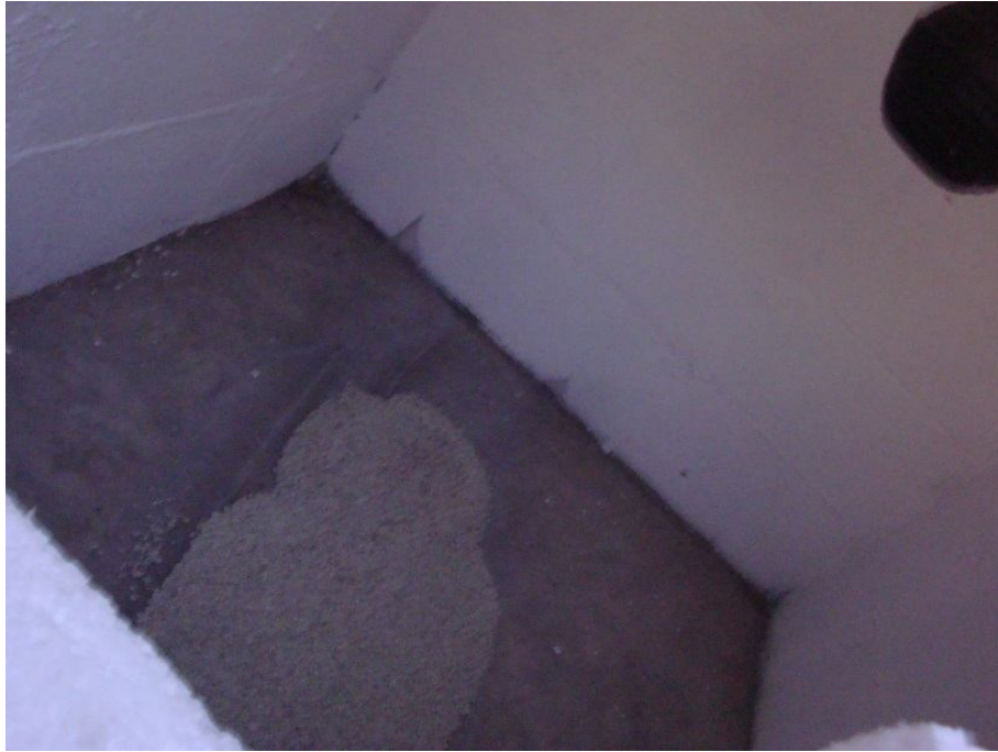
Fig. 102. Montaje experimento VI . Después de ser calentada y reposada la zeolita se introduce en el módulo experimental a las 18:47Hrs del 27 de Marzo de 2013. El módulo se cierra completamente con los paneles de poliestirreno a las 18:51 Hrs, del mismo día. Fuente: Propia
