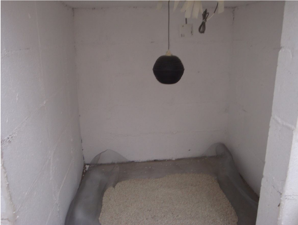
Fig.107. Montaje experimento IX. Colocación de la zeolita dentro del modulo experimental. Fuente: Propia
