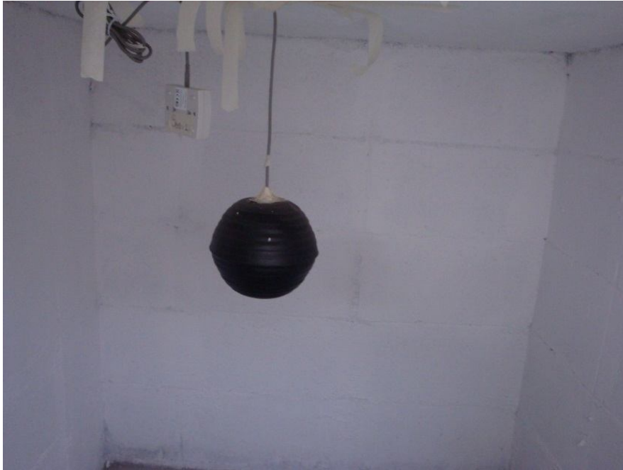
Fig. 100. Montaje experimento VI . Termómetro de Globo en una de las células de estudio. Fuente: Propia
