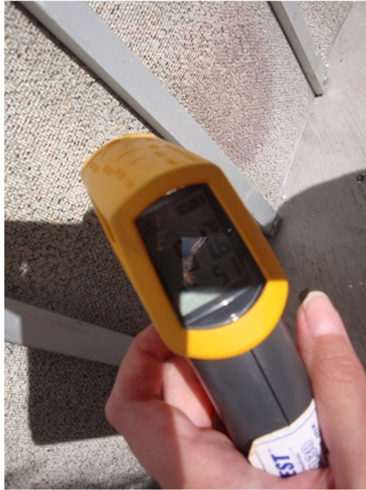
Fig.92. Medición de temperaturas en la zeolita con termómetro láser. Fuente: Propia
