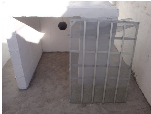
Fig.84. Montaje de Experimento II con 4 Kgs de zeolita en el artefacto desecante. Fuente: Propia
