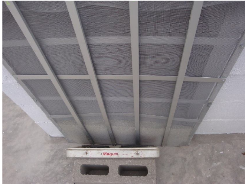
Fig.95. Montaje experimento V. La zeolita es calentada con una estufa eléctrica. Se pretende llevar el material desecante cerca de los 100°C para activar su capacidad absorbente. La zeolita es calentada por una hora antes de introducirse al interior del módulo experimental. Fuente: Propia
