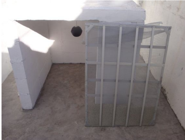
Fig. 88. Montaje de Experimento II con 4 Kgs de zeolita en el artefacto desecante. Célula experimental. Fuente: Propia
