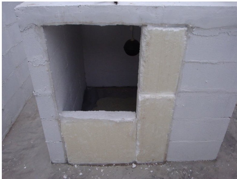
Fig.112. Montaje experimento X. Se cierran los módulos con los paneles de poliestireno. Fuent: Propia
