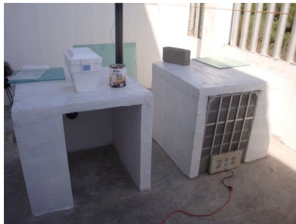
Fig.87. Montaje de Experimento II con 4 Kgs de zeolita en el artefacto desecante. Célula de control y Célula experimental. Fuente: Propia.
