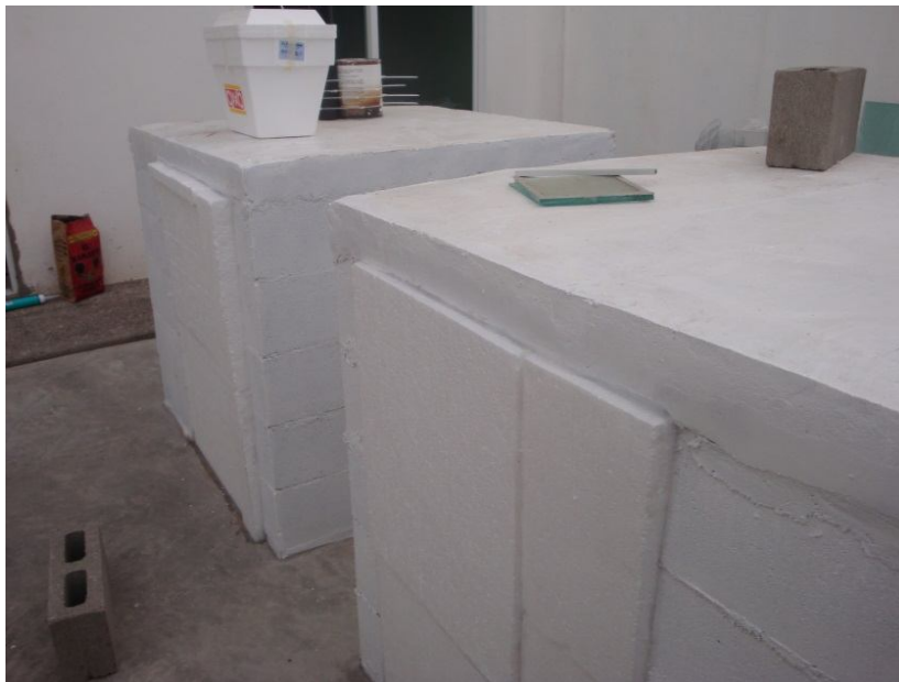
Fig.98. Montaje experimento V. Posteriormente se sella la célula experimental con los paneles de poliestireno. La célula de control se sella de igual forma con los paneles de poliestireno. Fuente: Propia
