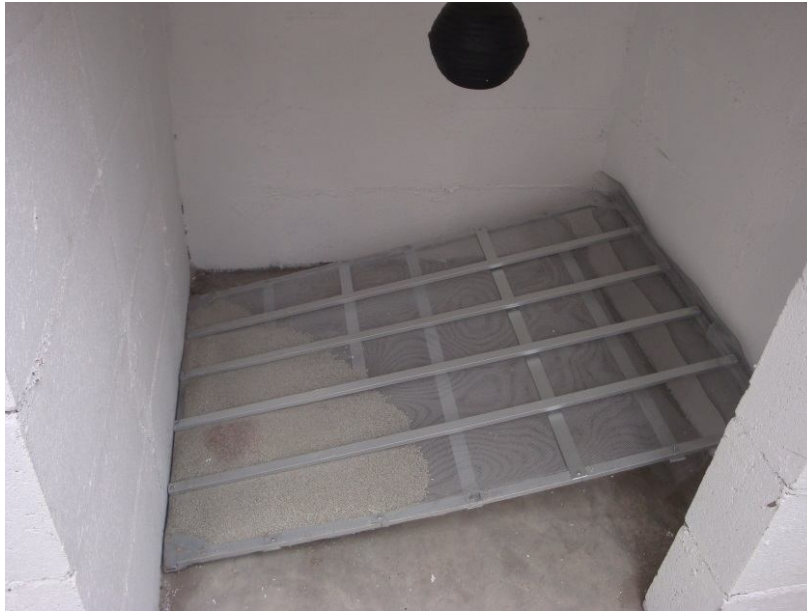
Fig.97. Montaje experimento V. Se introduce el artefacto desecante con la zeolita caliente. Posteriormente se sella la célula experimental con los paneles de poliestireno. Fuente: Propia
