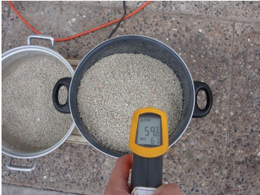
Fig.106. Montaje experimento IX . Calentamiento de la zeolita. Fuente: Propia
