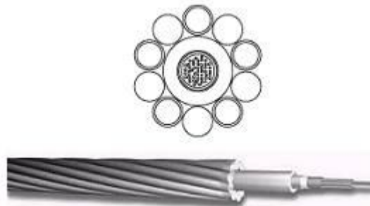
Fig. 2.14. Cable de Guarda con Fibras Ópticas OPGW.
