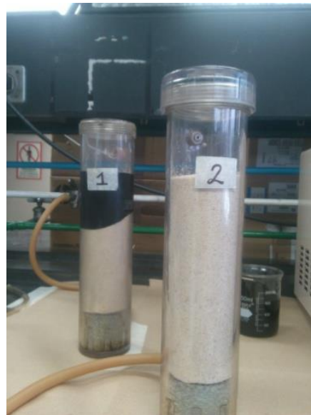
Figura 2.5. Impregnación de columnas.
