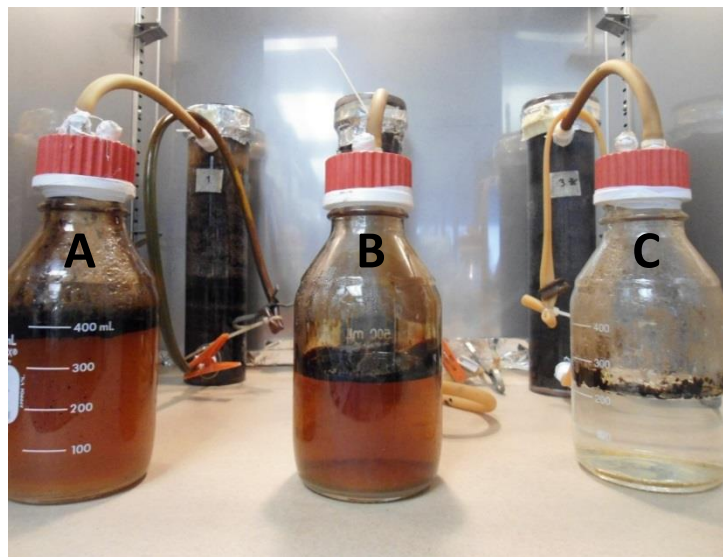
Figura 3.16. Recuperación de aceite de densidad media después de la primera inyección de microorganismos. Los frascos A y B corresponden a las columnas que contenían bacterias y el frasco C a la columna control.
