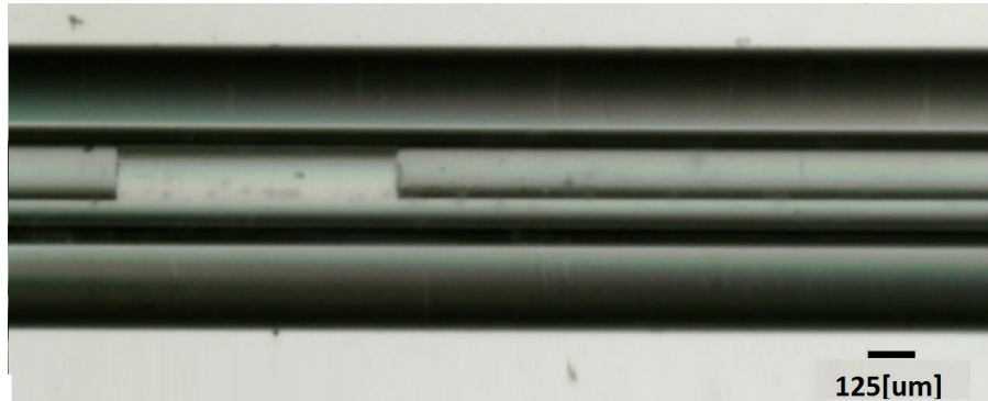
Figura D.3: Fibras ópticas dentro de un capilar a una distancia de 578.2\mu m
