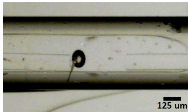
Figura 3.6: Muestra después de generada la burbuja.
