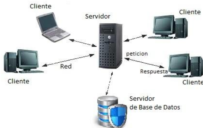
Figura 4.1. Arquitectura Cliente/Servidor en 3 capas. El cliente realiza la petición al servidor a través de la red, el servidor procesa la información, hace una consulta al servidor de base de datos y obtiene un resultado. Finalmente el servidor entrega una respuesta al cliente.
