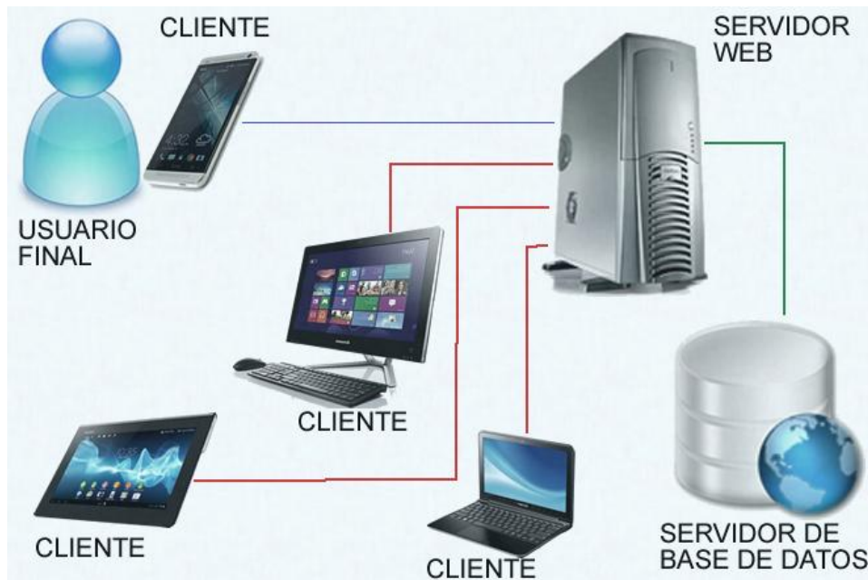
Figura 4.2. Implementación de la arquitectura Cliente/Servidor en 3 capas para la aplicación propuesta.
