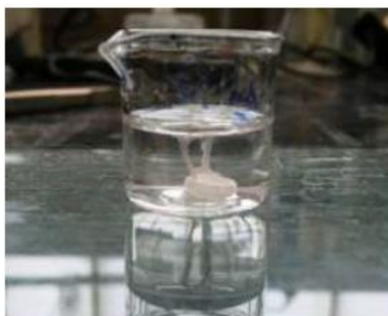
Figura 25. Proceso de precipitación de cloruro de plata al añadir gotas de una disolución de cloruro de potasio saturado en la disolución de nitrato de plata.
