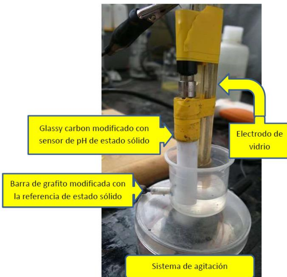
Figura 20. Montaje utilizado en el trazado de las curvas E = f(\text{pH}) con los SPE.
