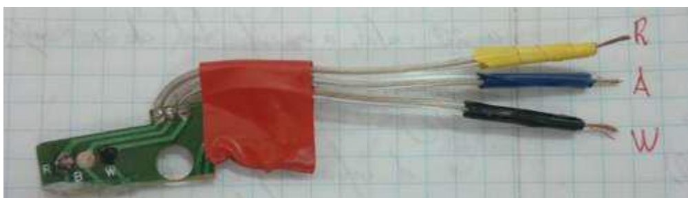
Figura 18. Pedazo de circuito impreso que se usó como soporte de la tinta de referencia y soporte de Nafion® + NTC's + PANI
