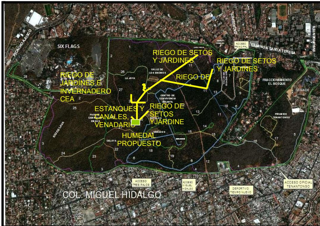
Figura 2.11. Distribución del agua tratada dentro del Bosque de Tlalpan (Google Earth 2013, modificado por personal del LMBE, FQ).
