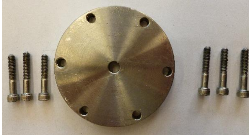
Figura 3.17 Tapa del cilindro y tornillos de fijación
