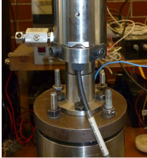
Figura 3.20 Sensor de presión del peróxido sujetado al cilindro
