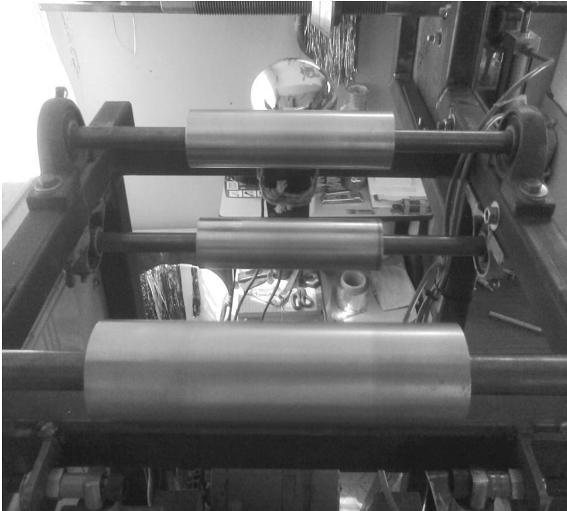
Fig. 4.22. Rodillos de alineación de papel.
