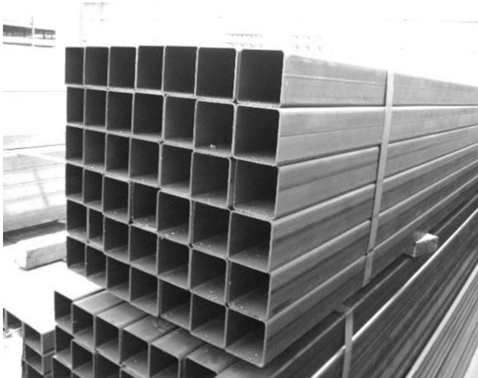
Fig.4.4. PTR estructural de acero A36.
