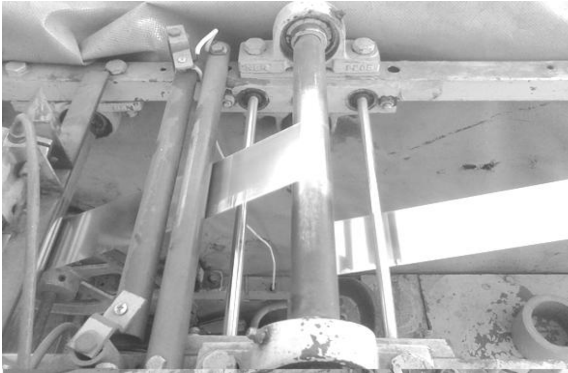
Fig. 3.5. Rodillos de alineamiento de papel.
