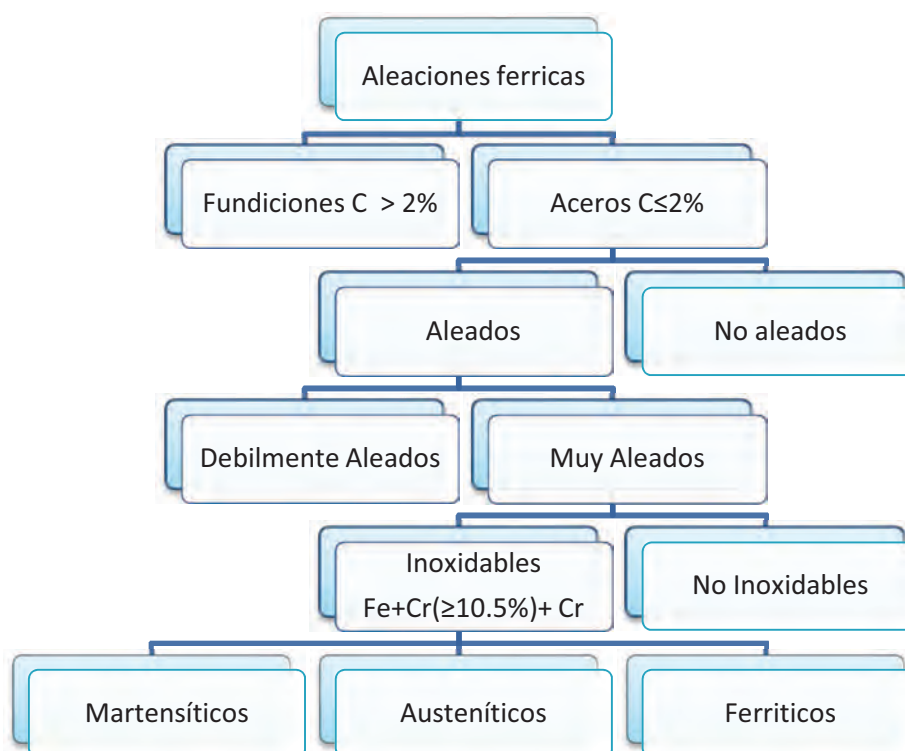
Figura 1. Árbol genealógico de los aceros inoxidables. Fuente: (Di Caprio 1999)
