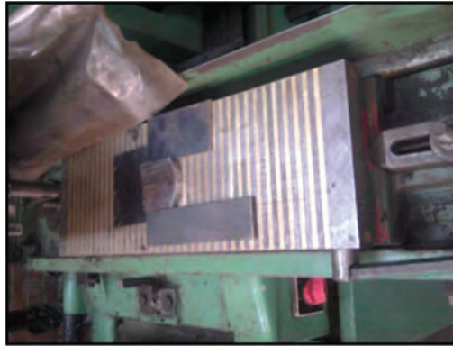
Figura 9. Fijado de las muestras para su rectificación.
