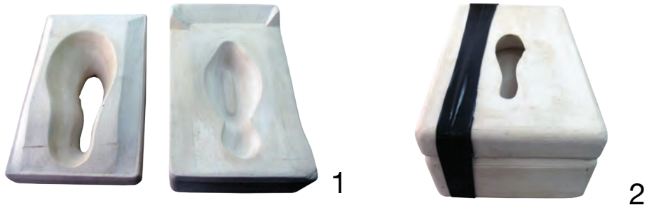
Armado de Molde.
