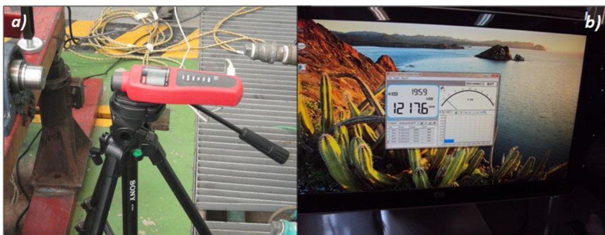
Figura 3.5. a) Tacómetro digital, b) Registro de rpm.
