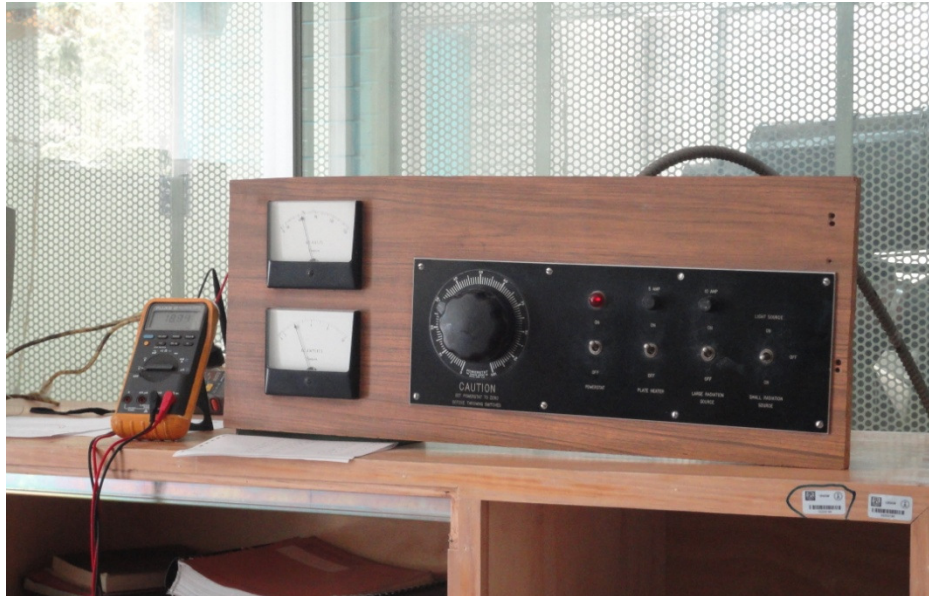
Figura 3.4. Suministro de corriente mediante el reóstato.
