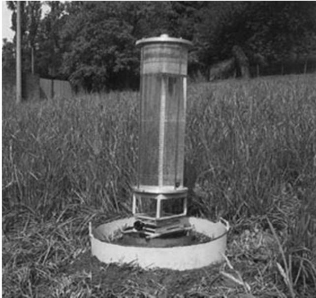
Foto 3.1. Infiltrómetro
