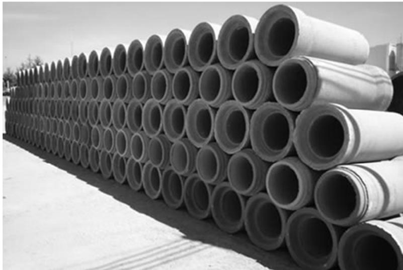
Foto 2.4. Tubería de concreto
