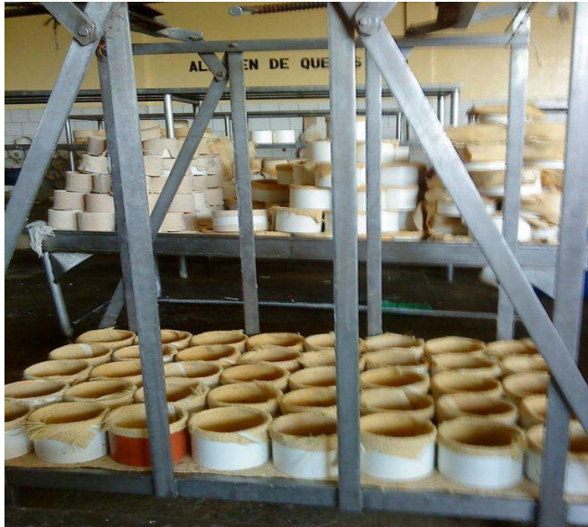
Aros con mallas de henequén para piezas de 1kg.
