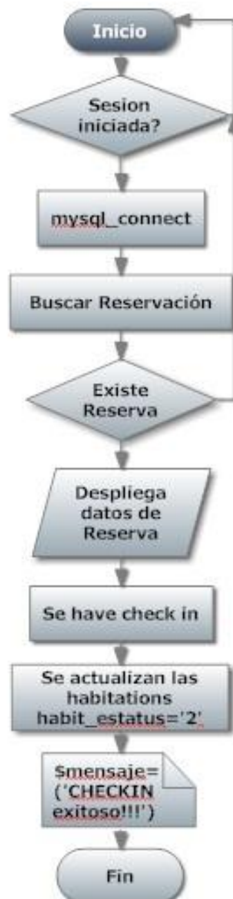
Figura 2.23. Diseño procedimental check-in
