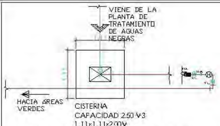
ALIMENTACIÓN A CISTERNA DETALLE D-2
