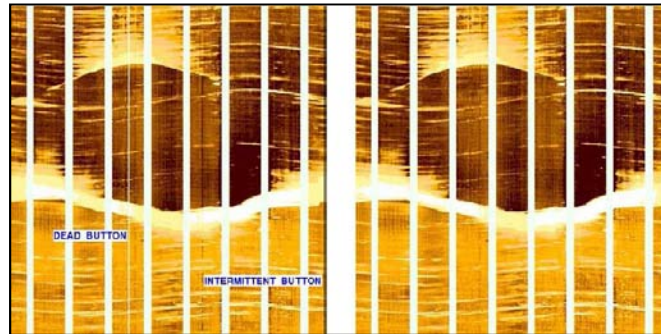
Figura 2.4. Corrección de botones malos. Izquierda: sin corrección. Derecha: con corrección. 17
