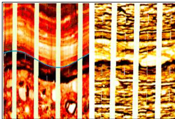
Figura 3.19 Discontinuidades vistas en una imagen eléctrica. Izquierda: Planar. Derecha: No planar. Escala: 1/5 vertical y 1/5 horizontal 43
