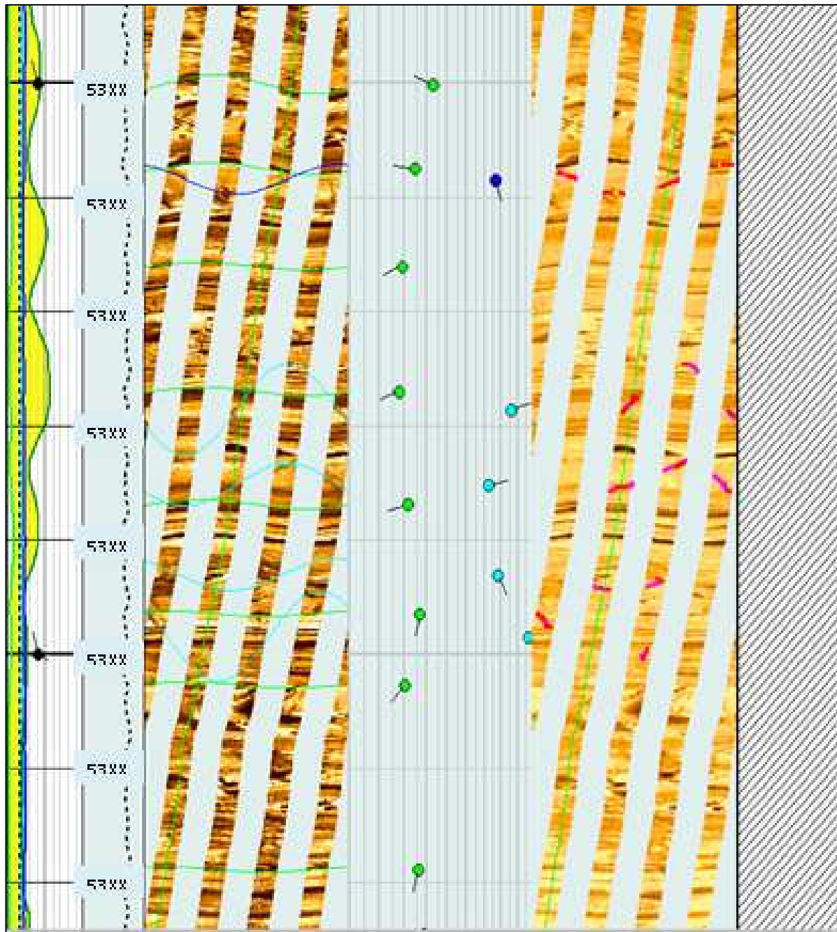
Figura 5.15 Ejemplo de una zona fracturada. Se observa como eventos parcialmente conductivos cortan las capas sin originar ningún tipo de desplazamiento.
