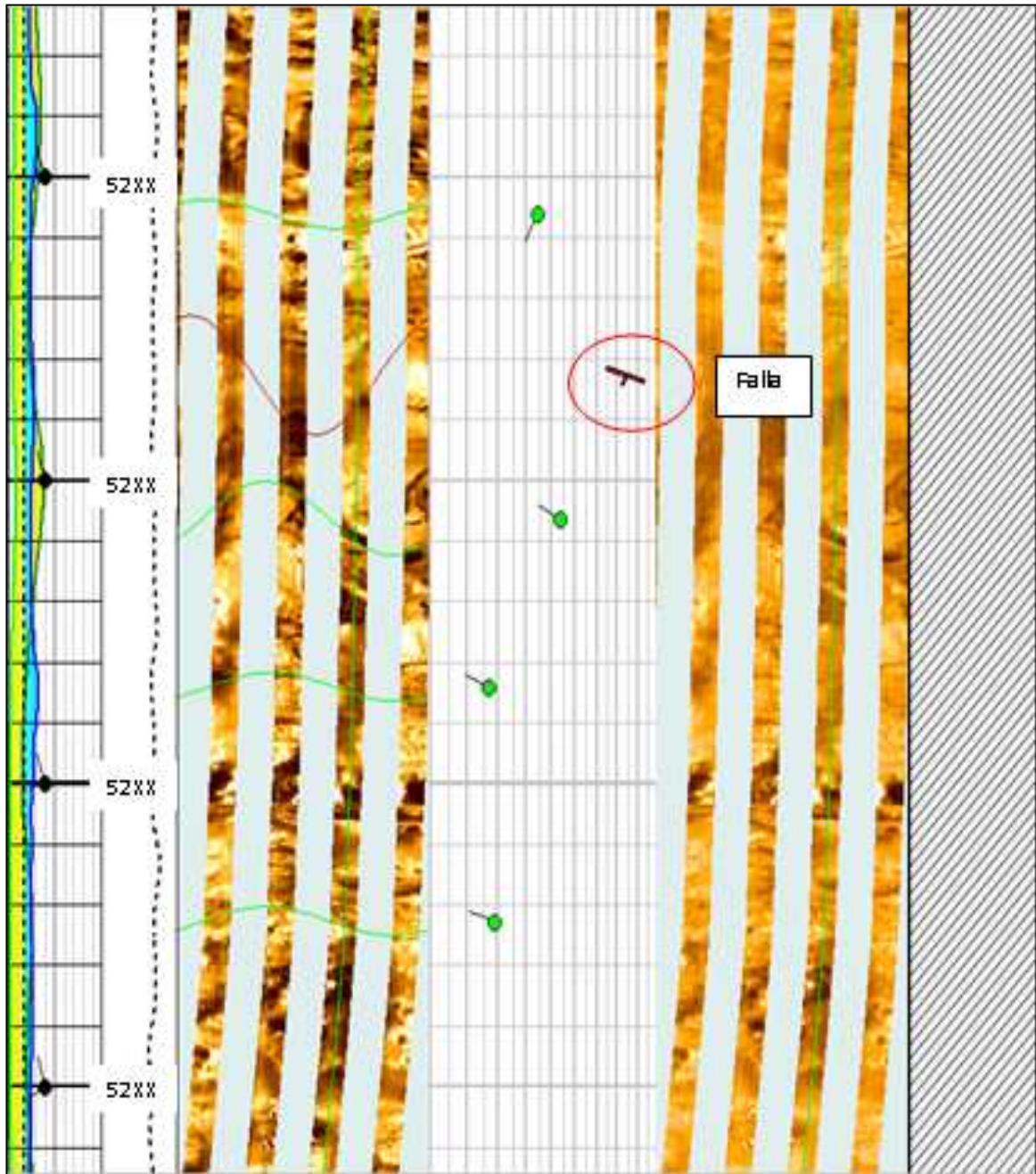
Figura 5.10 Imagen mostrando un ejemplo de una falla a la profundidad de ~@52XXm MD.
