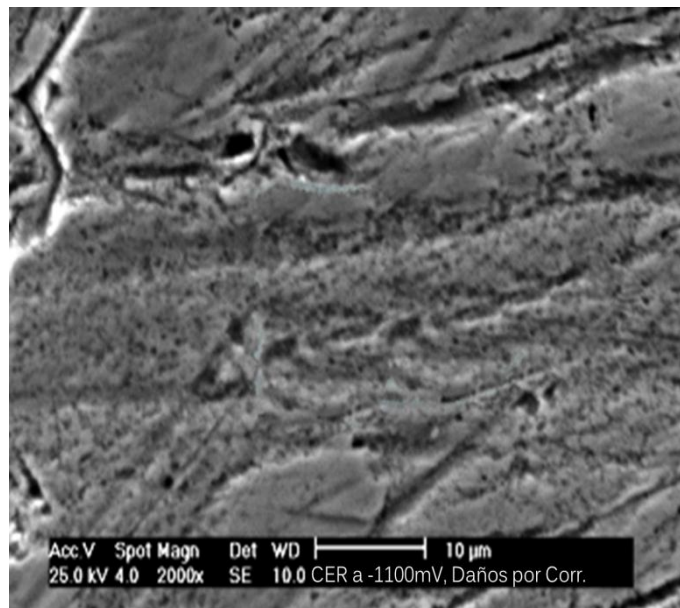
Figura 106. Superficie con zonas con corrosión generalizada y uniforme
