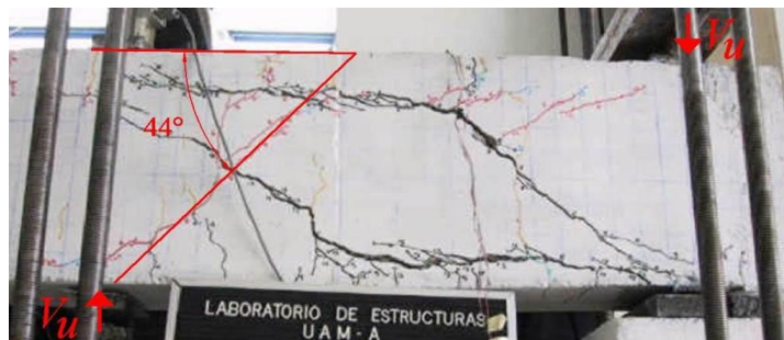
c) grieta crítica carga antigravitacional
