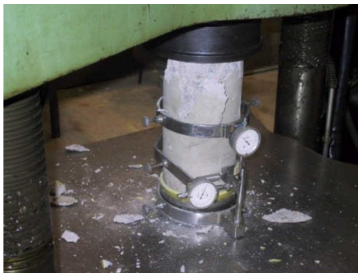
Figura J.1 Ensayo a compresión en cilindro de control
