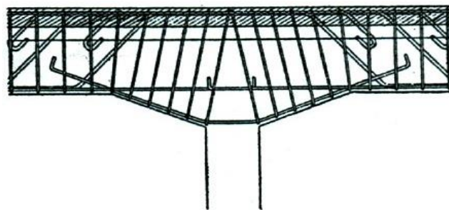
Figura 4.59 Armado especial recomendado por Morsch (1952) para mejorar el comportamiento ante momento positivo en las cartelas de travesas continuas
