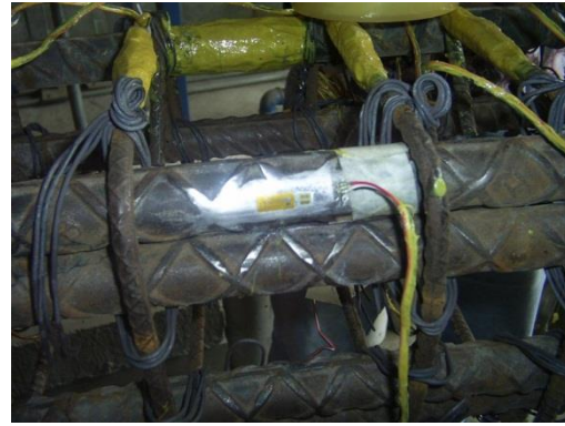
b) strain gage adherido al refuerzo
