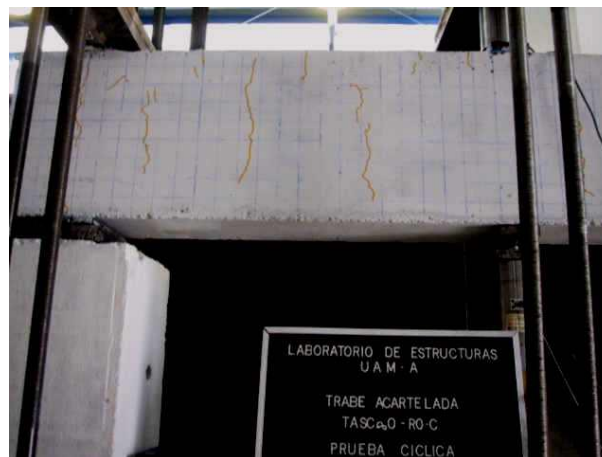
Figura 6.32 Elemento montado, cuadrículado y con grietas iniciales marcadas
