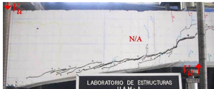
c) grieta crítica carga antigravitacional
